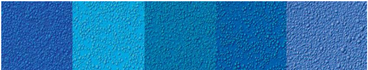
写真: 安定性試験に使用した、各種20%の油相のO/Wエマルジョン顕微鏡写真 (左から右): MIGLYOL® Coco 810, MIGLYOL® C-17, MIGLYOL® PPG 810, Sunflower Oil, Paraffin (倍率400x, 色は顕微鏡結像のフィルターに起因している。)
